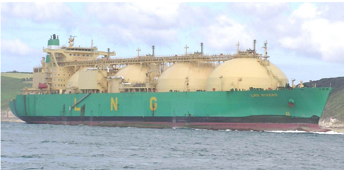
The LNG tanker LNG Rivers. This is a Moss-type LNG carrier with a capacity of 135,00 cubic metres (m 3 ). Image: Pline / CC BY-SA 3.0
